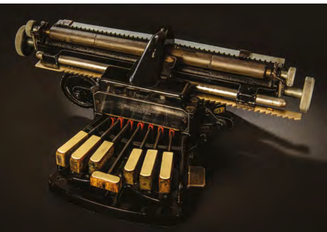
Marburški pisaći stroj, ZP413, stroj za pisanje brajice (foto R.V.)
