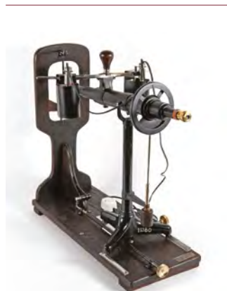
Oftalmometar Javal - Schiøtz, ZO4090 (foto D.Š.)
